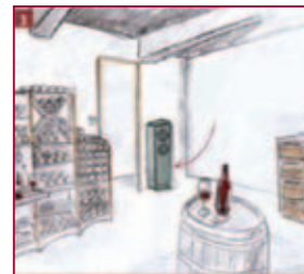
Gehäuse innen, am Boden angebracht.
